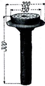
Nr. 1550 Badablauf 2" asphalt., mit Zementzarge, mit email. Lochrost Nr. 1550V desgl. mit emailiertem Rost ohne Loch
