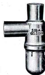
Nr. 50a Sibatrops nicht leersaugbar, mit abschraubbarer Tasse, 1 1/2 u. 2", Abgang 90°
