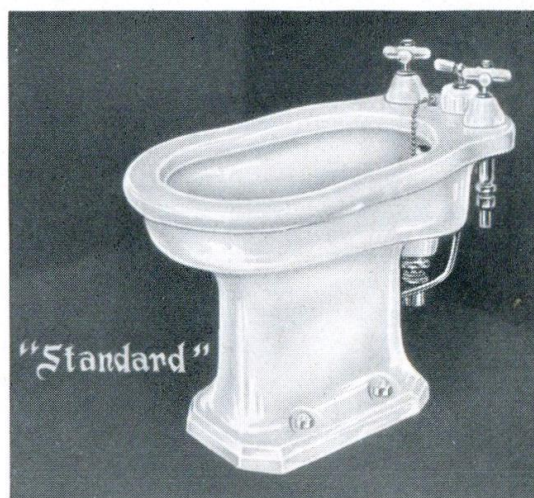
Nr. 813 (DF 5027 S) NERVI-Bidet komplett mit Bidetbatterie für Untermontage mit nichtsteigender Spindel und auswechselbarem Sitz, Umstellventil für Spülrand u. Unterdusche, Ablaufventil mit Stopfen, kleinem Kettenhalter mit Kugelkette Länge 600 mm, Breite 350 mm, Höhe 390 mm Dieses Bidet ist nur in Verbindung mit der vorstehend beschriebenen Armatur lieferbar
