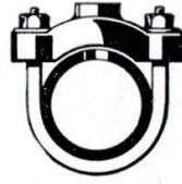
Nr. 169 Druck-Anbohrschelle m. Gewindeanschluß
