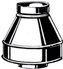
Nr. 1618 Windschutzhaube aus Aluminium oder ver- bleitem Eisenblech, als Zug- unterbrecher und Rückstau- sicherung, lichte Weite 100, 110, 120, 130, 150 mm
