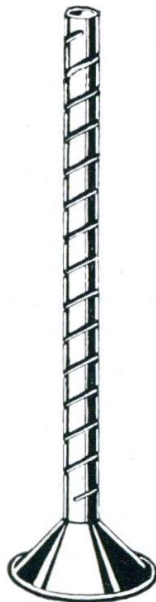
Nr. 1311 Flammrohr aus Kupfer und Unterboden, Länge ca. 1450 mm, Trichterdurchmesser 315 u. 335 mm, Blechstärke 0,7-1 mm
