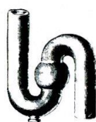
Bleikugeltraps , Wasserstand 8 cm Nr. 26 S-Form
