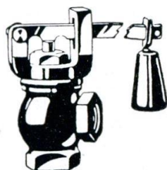
Nr. 225 Eck-Sicherheitsventil aus Rotguß mit Jenkinsdichtung, \frac{1}{2} - 1\frac{1}{4} "
