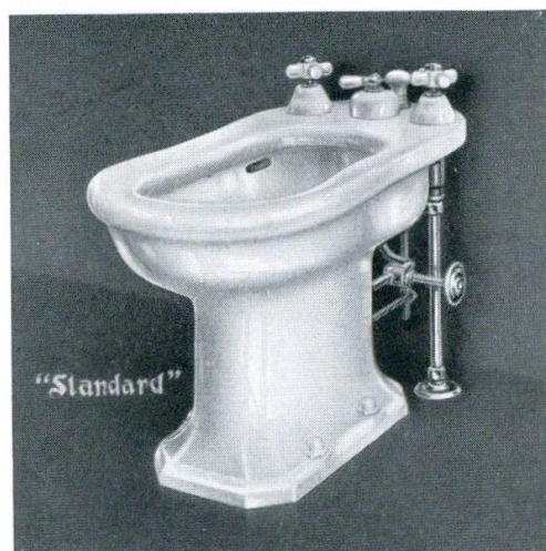
Nr. 812 (DF 5000) MENLO-Bidet komplett mit Bidetbatterie für Untermontage mit nichtsteigender Spindel u. auswechselbarem Sitz, Unterdusche mit Regulierventil für Spülrand und Unterdusche, Ab- und Überlaufvorrichtung 1\frac{1}{4} "", Exzenterbetätigung durch Hubknopf, Zuflußrohre \frac{3}{8} "", für Quetschverschraubung mit Bodenrosetten Länge 670 mm, Breite 390 mm, Höhe 385 mm
