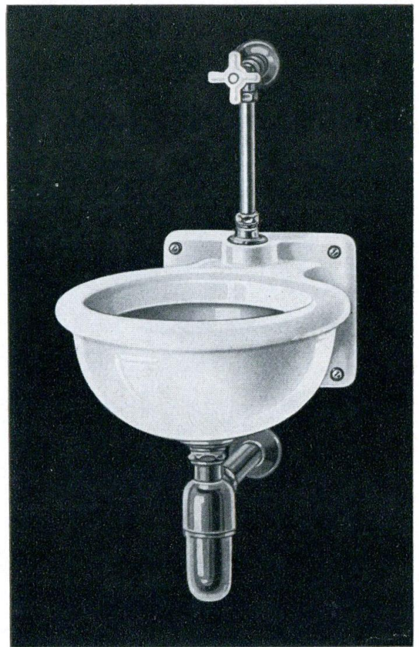
Nr. 803 (4361) Mundspülbecken aus Edel-Feuerton, mit Wandflansch für die Befestigung, das Becken mit Randspülung und Zulauf von oben, mit Urinal-Eckhahn, Einlaufspund und Metallsiphon
