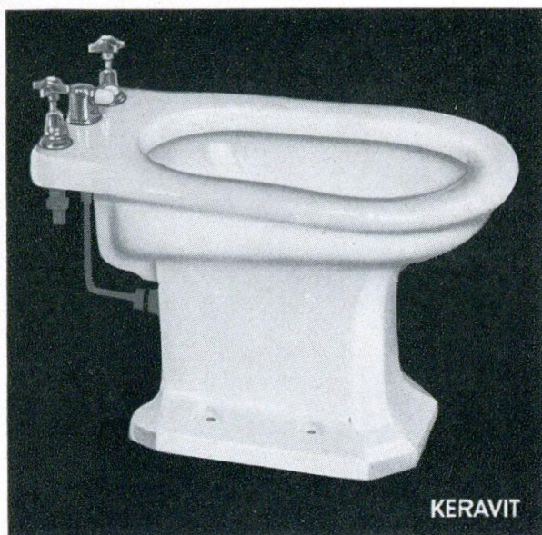
Nr. 810 Bidet aus „Keravit“-Porzellan in kantiger, moderner Form, mit Messing=vernickelten Füllhähnen für kaltes und warmes Wasser, Ab- und Überlaufvorrichtung mit Umlegehebel sowie Messing=vernickeltem Siphon mit Verlängerungsrohr und Rosette
