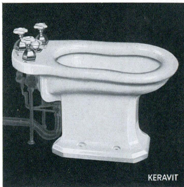
Nr. 811 Bidet aus „Keravit“-Porzellan in kantiger, moderner Form, mit kompletter Unterbeckenbatterie mit Umschaltung für Beckenfüllung und Unterdusche, Ab- und Überlaufvorrichtung mit Zugknopf, Siphon mit Verlängerungsrohr und Rosette
