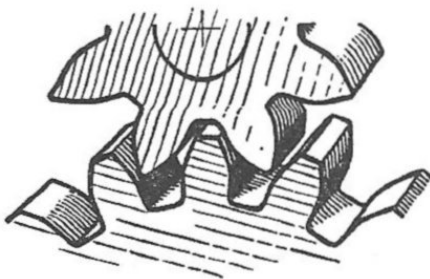
Abb. 23. Gerade Zähne wälzen sich aufeinander ab.
