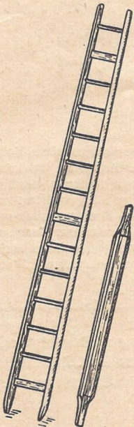
Nr. 150 Anlegeleiter , mit aufgesägten Holmen, besonders kräftigen, vierkantig eingepreßten Eschesprossen.
