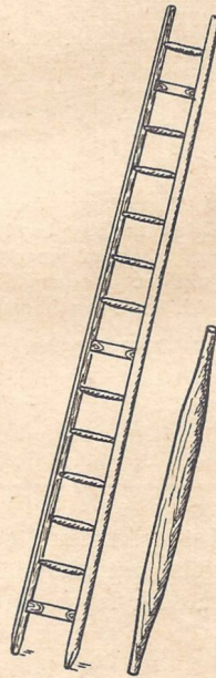
Nr. 154 Anlegeleiter , mit aufgesägten Holmen, runde Sprossen aus Fichteknuppeln.
