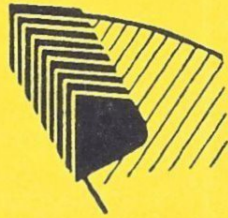
Schleifvorgang bei Coromant- Fräsern 226 und 227
