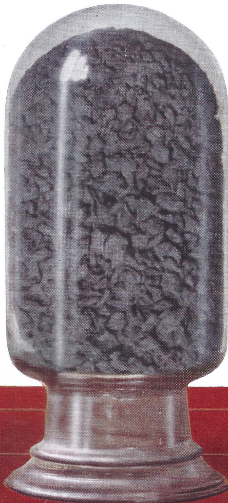
Die gewonnenen Filzfasern ergeben eine festgefügte Grundlage (Feltbase) für die gemusterte Oberschicht
