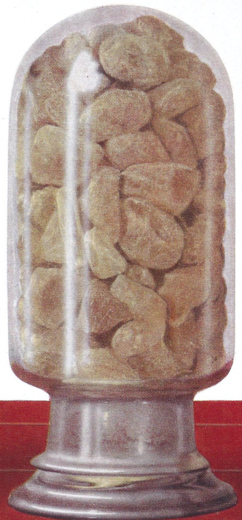
Neben der isolierenden und die Elastizität erhöhenden Imprägnierung des Filzgrundes steigert reines Kopalharz die Festigkeit des Belages
