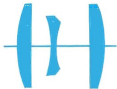
Agfa Agnar, Dreilinser, schematisch dargestellt
