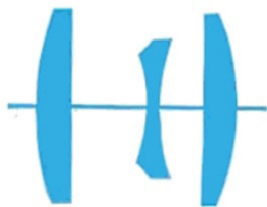
Agfa Color-Apotar Dreilinser schematisch dargestellt
