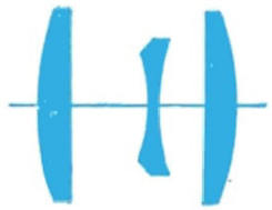
Agfa Color-Apotar Dreilinser schematisch dargestellt
