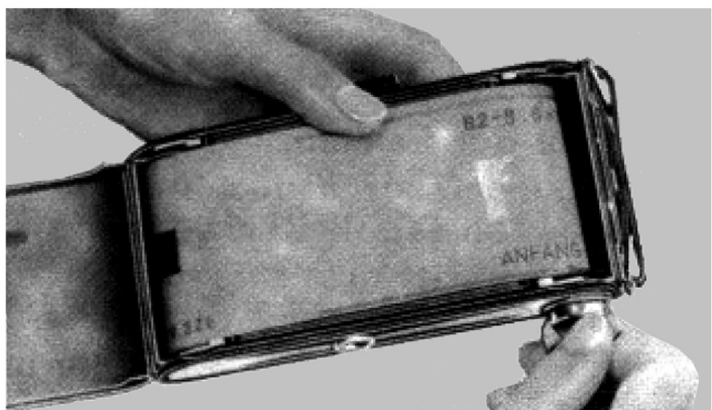
Abb. 10. Das Vorspulen des Schutzpapiers
