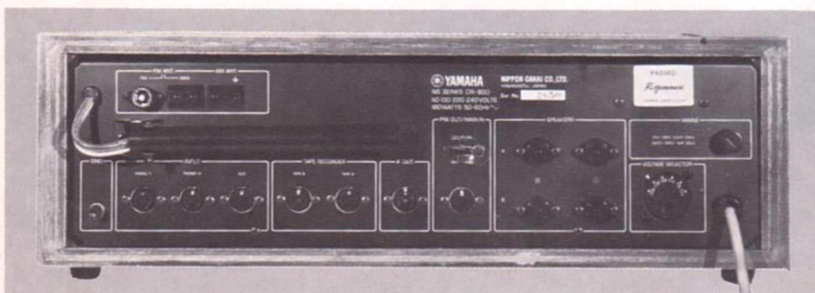
1 Rückseite des CR 800 Empfänger-Verstärkers mit Mittelwellen-Ferritantenne und DIN-Anschlußbuchsen
