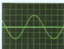
B: Exakt dimensionierte ZDR bewirkt Auslöschung der Verzerrungskurve.
