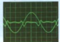
C. Experimentelle Überdimensionierung der ZDR. Negative Abbildung der ursprünglichen Verzerrungskurve.
