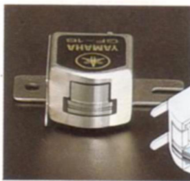
Rein-Sendust-Niederimpedanz-Tonkopf in 5schichtiger Laminarbauweise
