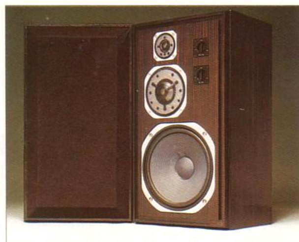
スピーカーシステム NS-1000 ¥145,000 (1台) 真空蒸着法により実用化に成功したベリリウム振動板採用のツイータ・スコーカ。コーン紙から開発した高性能ウーファによる3ウェイ。黒檀仕上げです。 ●型式3ウェイ密閉ブックシェルフ型 / 最大許容入力100W / 出力音圧レベル90dB / W.m / 395W × 710H × 349Dmm / 39kg
