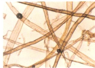
Mikro-Foto des Fichten-Membran-Materials
