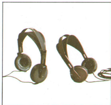
HP-1/2/3: Casques d'écoute orthodynamique dessinés par Mario Bellini. Bobine mobile insérée dans la membrane. Puissance: 3 Watts. Réponse en fréquences très large et linéaire: 20 à 20.000 Hz. Impédance 150 Ohms.
