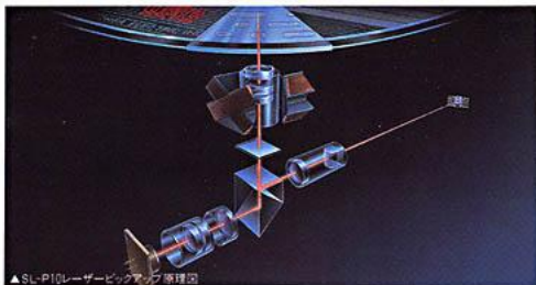
▲SL-P10レーザービックアップ 原理図
