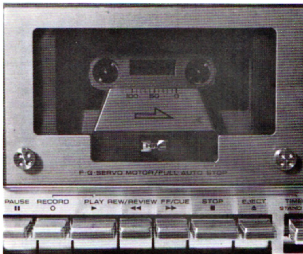
La porte protégeant la cassette peut facilement se démonter pour l'entretien des têtes.
