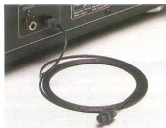
Optischer und elektrischer Digitalausgang (SL-P990)
