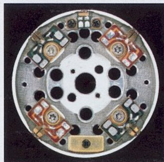
8 Videoköpfe: – 4 für Standardplay – 4 für Longplay – rotierender Löschkopf für den Insertschnitt
