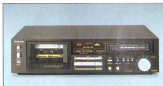
RS-M 273 Microprozessorgesteuertes Stereo-Cassette-Deck. 2 Motoren, Doppel-Capstan-Antrieb, SX 3 Kopf-System, Hinterbandkontrolle, Auto-Tape-Select. Reineisenbandbetrieb, elektronisches Bandzählwerk, Memory Repeat und Stop, Dolby. Übertragungsbereich 20 Hz-19 kHz bei Reineisenband. FL-Aussteuerungsanzeige mit „peak-hold“. Gehäusefarbe: schwarz.
