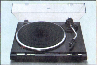
SL-Q 202 Halbautomatischer Plattenspieler mit quarzgeregeltem Direktantrieb. Hochwertiger Magnettonabnehmer EPC-U 25. Gleichlaufschwankungen ± 0,035%. Gehäusefarbe: schwarz + silber.
