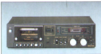
RS-M 215 Stereo-Cassette-Deck für Reineisenbandbetrieb. FL-Meter, Leichthubtasten, Dolby, MX-Aufsprech-/Wiedergabekopf für Reineisen. Übertragungsbereich 30 Hz-15 kHz bei Reineisenband. Eingangswahlschalter LINE/MIC (DIN). Bereitschaft für Timer-Betrieb. Gehäusefarbe: schwarz + silber.
