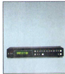
TE-96 Schaltuhr mit LCD-Anzeige. Schaltmöglichkeit: 4 Programme innerhalb 1 Woche über zwei unabhängige Stromkreise. Max. Anschlußlast: 1.100 W pro Stromkreis, Breite: 43 cm. Gehäusefarbe: schwarz.
