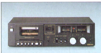
RS-M 205 Stereo-Cassette-Deck für Reineisenbandbetrieb. Leichthubtasten, Dolby, MX-Aufsprech-/Wiedergabekopf für Reineisen. Übertragungsbereich 30 Hz-15 kHz bei Reineisenband. Bereitschaftsschaltung für Timer-Betrieb. Gehäusefarbe: schwarz + silber.
