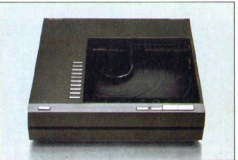
SL-15 Vollautomatischer Plattenspieler mit quarzgeregeltem Direktantrieb, servogeregelter Tangentialtonarm mit Magnettonabnehmer EPC-P 205CMC3. Musik-Selektor zum Vorwählen von bis zu 10 Musikstücken. Gleichlaufschwankungen ± 0,035%. Horizontal- u. Vertikalbetri möglich. Gehäusef.: schwarz.
