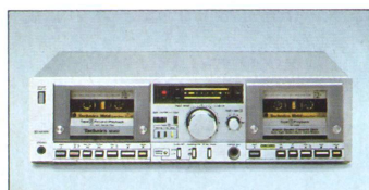
RS-M 202 Stereo-Cassette-Deck mit 2 Cassettenteilen zum Duplizieren: Tape 1 Wiedergabe, Tape 2 Wiedergabe/Aufnahme, Dubbing-Funktion, Leichthubtasten, SX-Aufnahme-/Wiedergabe-Köpfe, Auto-Tape-Select. Übertragungsbereich 30 Hz-17 kHz bei Reineisenband. 2farbige Aussteuerungsanzeige mit „peak-hold“. Gehäusefarbe: silber.
