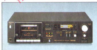
RS-M 263 3-Kopf-Stereo-Cassette-Deck mit Hinterbandkontrolle. Reineisenbandbetrieb, Dolby. Automatischer Bandsortenwähler. Regelbare Vormagnetisierung (BIA), FL-Aussteuerungsanzeige mit „peak-hold“. Ausgangspegelregler. Leichthubtasten. Gehäusefarbe: schwarz und silber.
