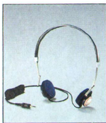
EAH-01 Superleichter HiFi-Kopfhörer. Frequenzgang: 20-20.000 Hz, Empfindlichkeit 98 dB/mW, Gewicht 35 g.
