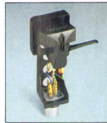
EPC-300 MC Dynamischer Tonabnehmer mit zwei kernlosen Doppelringspulen. Nitriergehärteter Titan-Nadelträger. Ellipt. Diamant. Übertragungsbereich 10-50.000 Hz.
