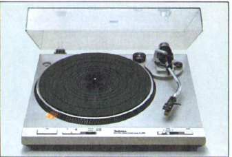
SL-D 202 Halbautomatischer Plattenspieler mit Direktantrieb. Hochwertiger Magnettonabnehmer EPC-U 25. Geschwindigkeitsfeinregulierung ± 5%. Gleichlaufschwankungen ± 0,035%. Gehäusefarbe: schwarz + silber.
