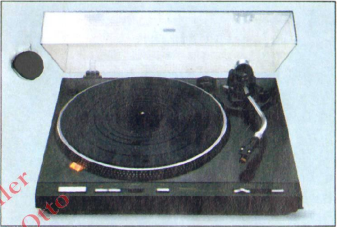
SL-D 303 Vollautomatischer Plattenspieler mit Direktantrieb. Automatische Abtastung der Plattengröße. Hochwertiger Magnettonabnehmer EPC-U 25. Wiederholautom. Geschwindigkeitsfeinregulierung ± 5%. Gleichlaufschwankungen ± 0,035%. Gehäusefarbe: schwarz + silber.
