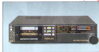
RS-M 280 3-Kopf-Stereo-Cassette-Deck mit Hinterbandkontrolle. 3 Motoren, Reineisenbandbetrieb, Dolby, Doppel-Capstan-Antrieb, quartzeregelter Direktantrieb der Tonwellen, Leichthubtasten. Übertragungsbereich 20 Hz-20 kHz bei Reineisenband. 2farbige FL-Aussteuerungsanzeige mit „peak-hold“, elektronisches Bandzählwerk. Eichoszillatoren 400 Hz/8 kHz. Gehäusefarbe: schwarz.
