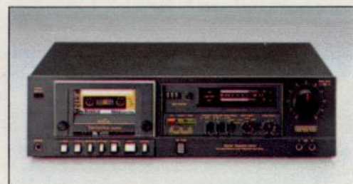
RS-M 260 3-Kopf-Stereo-Cassetten-Deck mit Hinterbandkontrolle. Reineisenbandbetrieb, Dolby. Übertragungsbereich 30-18.000 Hz bei Reineisenband. Leichthubtasten, FL-Aussteuerungsanzeig mit „peak-hold“. Gehäusefarbe: schwarz + silber.
