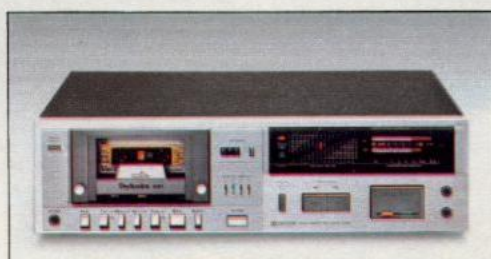
RS-M 51 Cassette-Deck für Reineisenbandbetrieb, automatische Aufnahme-Aussteuerung, Auto-Tape-Select (Normal-CrO 2 -Reineisenband). Leichthubtasten, Dolby. Übertragungsbereich 30-18.000 Hz bei Reineisenband. 2farbiges FL-Aussteuerungsanzeig mit „peak-hold“. Zusätzlich erhältlich: Kabel-Fernbedienung RP-9624. Gehäusefarbe: schwarz + silber.
