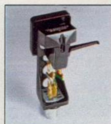
EPC-300 MC Neuer dynamischer Tonabnehmer mit zwei kernlosen Doppelringspulen. Nitriergeschützter Titan-Nadelträger. Ellipt. Diamant. Übertragungsbereich 10-50.000 Hz.
