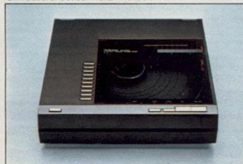
SL-15 Vollautomatischer Plattenspieler mit quarzgeregeltem Direktantrieb, servogeregelter Tangentialtonarm mit Magnettonabnehmer EPC-202. Musik-Selektor zum Vorwählen von bis zu 10 Musikstücken. Gleichlaufschwankungen \pm 0,035\% . Horizontal- und Vertikalbetrieb möglich. Gehäusefarbe: schwarz.
