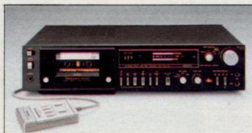
RS-M 270 X Stereo-Cassetten-Deck mit dbx-Rauschunterdrückungs-System, Dolby, MIC/LINE-Eingangswahlschalter, IC-Logic-Schaltung, 2 direkt angetriebene Motoren, SX-Tonkopf. Übertragungsbereich 25 Hz-18 kHz bei Reineisenband. 2farbiges FL-Aussteuerungsanzeig mit „peak-hold“. Anschlußmöglichkeit für Zeitschaltuhr. „dbx-disc“-Position – Möglichkeit der Decodierung von dbx-codierten Schallplatten. Gehäusefarbe: schwarz.
