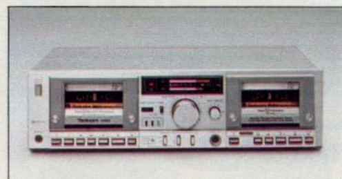
RS-M 202 Stereo-Cassetten-Deck mit 2 Cassettenteilen zum Duplizieren: Tape 1 Wiedergabe, Tape 2 Wiedergabe/Aufnahme, Dubbing-Funktion. Leichthubtasten. SX-Aufnahme/Wiedergabe-Köpfe. Auto-Tape-Select. Übertragungsbereich 30 Hz-17 kHz bei Reineisenband. 2farbiges Aussteuerungsanzeig mit „peak-hold“. Gehäusefarbe: silber.
