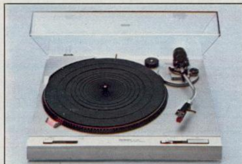
SL-B 202 Halbautomatischer Plattenspieler mit Riemenantrieb. Geschwindigkeitsfeinregulierung \pm 3\% . Hochwertiger Magnettonabnehmer EPC-U 25. Gleichlaufschwankungen \pm 0,06\% . Gehäusefarbe: schwarz + silber.
