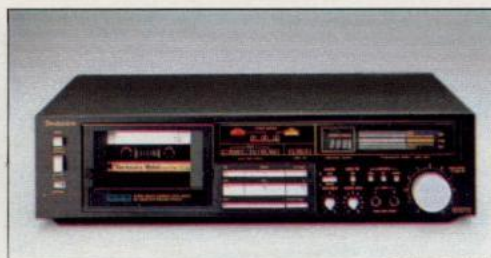
RS-M 273 Microprozessorgesteuertes Stereo-Cassetten-Deck. 2 Motoren, Doppel-Capstan-Antrieb, SX-3-Kopf-System, Hinterbandkontrolle, Auto-Tape-Select. Reineisenbandbetrieb, elektronisches Bandzählwerk, Memory Repeat und Stop, Dolby. Übertragungsbereich 20 Hz-19 kHz bei Reineisenband. FL-Aussteuerungsanzeig mit „peak-hold“. Gehäusefarbe: schwarz.
