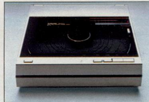
SL-10 Vollautomatischer Plattenspieler mit quarzgeregeltem Direktantrieb, servogeregelter Tangentialtonarm mit MC-Tonabnehmer EPC-310 MC. Eingebauter MC-Vorverstärker. Automatische Abtastung der Plattengröße durch Infrarot-Sensor. Gleichlaufschwankungen \pm 0,035\% . Horizontal- und Vertikalbetrieb möglich. Gehäusefarbe: silber.
