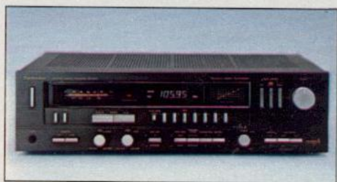
SA-424 UKW/MW-Stereo-Receiver. New Class A -Technik. Ausgangsleistung 2 x 55 W (Sinus, 4 Ohm). Quarz-Synthesizer Abstimmsystem mit digitaler und analoger Frequenzanzeige. 7 UKW- und 7 MW-Stationstasten. Klirrfaktor 0,001%. Gehäusefarbe: schwarz.
