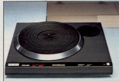
SL-151 MK 2 Quarzgeregeltes, direktantriebenes Laufwerk ohne Tonarm. LED-Anzeige für Geschwindigkeit und Feinregulierung. Geschwindigkeitsfeinregulierung in 0,1%-Schritten bis max. \pm 9,9\% . Gleichlaufschwankungen \pm 0,035\% . Gehäusefarbe: schwarz.
