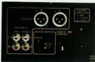
Auch auf der Rückseite des DX-6890 findet sich nur das Beste - variable, schaltbare Analog- und optische Digitalausgänge. Daneben professionelle, symmetrische XLR-Ausgangsbuchsen mit eigener Masseschleife und effektiver Rauschabschirmung.
