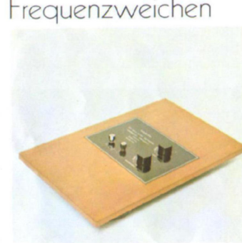
NT 84 A Frequenzweiche für 4-Weg und 3-Weg-Lautsprechersyst. Impedanz: 8 Ohm, Übergangsfreq.: 700/5000/9000 Hz, Baß: 12 dB/okt., Mittelt.: 12 u. 6 dB/okt., Hocht.: 12 dB/okt., Superhocht.: 6 dB/okt., Belastbarkeit: 60 Watt (Musik).
