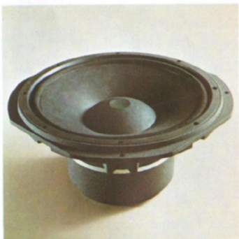
W 38 A „MK-II“ Type: 38 cm Baßlautspr. 8 Ohm, Frequenzumf.: 17–2000 Hz, Belastbar.: 80 Watt, Schalldruckpegel 104 dB/W/m
