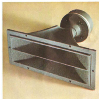
HM 450 A 34 x 15 cm Mittellton-Horn 8 Ohm, Frequenzumfang: 600–13 000 Hz, Belastbarkeit: 30 Watt, Schalldruckpegel: 106 dB/W/m
