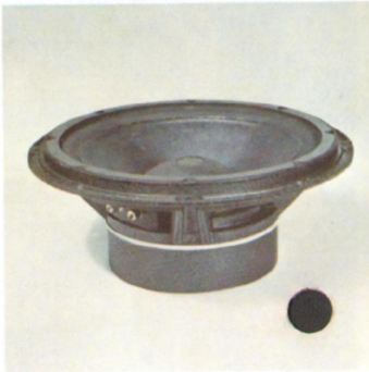
W 30 A „MK-II“ Type: 34 cm Baßlautspr. 8 Ohm, Frequenzumf.: 20–2000 Hz, Belastbarkeit: 60 Watt, Schalldruckpegel: 104 dB/W/m
