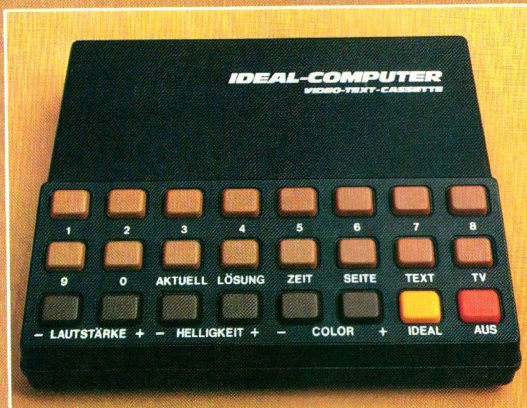
VIDEO-TEXT-Bedienung-Cassette von ITT zur Steuerung von Fernsehprogramm und Bildschirmzeitung (Bestandteil eines Nachrüstsets).
