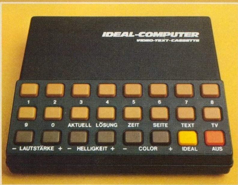
VIDEO-TEXT -Bedienungs-Cassette von ITT zur Steuerung von Fernsehprogramm und Bildschirmzeitung (Bestandteil eines Nachrüstsets).
