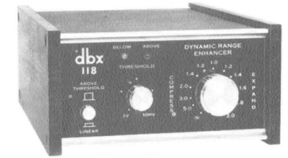
Modell 118 separate Einheit der Kompressions/Expansions Funktion wie in Modell 128 zur Dynamikerweiterung.
