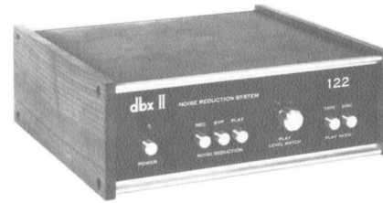
Modell 122 bietet in einer separaten Einheit die Compressor Funktion des Modells 128
