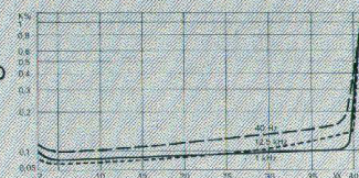
Klirrfaktor in Abhängigkeit von der Aussteuerung bei 40 Hz, 1 kHz und 12,5 kHz.
