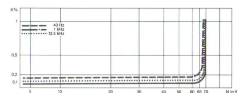
Klirrfaktor in Abhängigkeit von der Aussteuerung bei 40 Hz, 1 kHz und 12,5 kHz.
