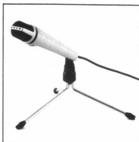
Dynamisches Stab- Richtmikrophon M 534 Tischmikrophon mit Nieren- charakteristik. Sprache-Musik- Umschalter. Frequenzbereich: 50–16 000 Hz.
