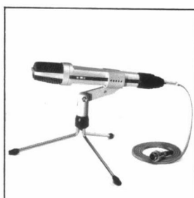
HiFi-Richtmikrophon M 537 Hochleistungs-Mikrophon mit Nierencharakteristik. Elastisch gelagertes Mikrophon-System. Eingebauter Sprache/Musik- schalter, komplett mit Stativ- anschlußteil M 937 und Tisch- stativ M 923, ohne Anschluß- kabel. Frequenzbereich: 40–18 000 Hz.
