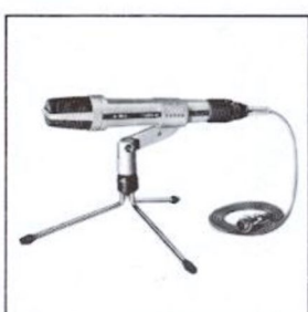
M 537 HiFi-Richtmikrofon Hochleistungs-Mikrofon mit Nierencharakteristik. Elastisch gelagertes Mikrofon-System. Eingebauter Sprache/Musik-Schalter, komplett mit Stativanschlußteil M 937 und Tischstativ M 923. Frequenzbereich: 40–18 000 Hz.
