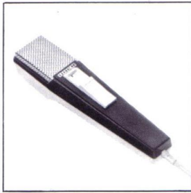
M 154 Dynamisches Diktiermikrofon Das „sprechende“ Diktiermikrofon mit Steuerschalter für Aufnahme, Wiedergabe, Stop und Wiederholung. Frequenzbereich: 150–10 000 Hz.
