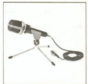
M 517 Dynamisches Fernsteuer-Mikrofon Spezialmikrofon mit Start/Stop- und Sprache/Musik-Schalter ohne Stativ. Nierenförmige Richtcharakteristik. Durch Windschutzkappe besonders auch für Außen- aufnahmen geeignet. Frequenzbereich: 50–15 000 Hz. M 923 Tischstativ
