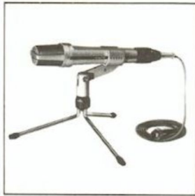
M 538 Zweiweg-Studiomikrofon Hochleistungs-Mikrofon mit Nierencharakteristik. Zweiweg-Technik. Sinterbronzekappe, dadurch wind- und staubgeschützt, komplett mit Stativanschlußteil M 937 und Tischstativ M 923. Ohne Anschlußkabel. Frequenzbereich: 30–18 000 Hz.
