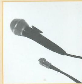
M 518 A Dynamisches Reporter-Mikrofon mit Fernsteuerung (mono) Mit Start/Stop-Schalter. Mit eingeb. Windschutz für Außenaufnahmen. Charakteristik: Niere Empfindlichkeit: 2,8 mV/Pa Frequenzbereich: 50-15000 Hz Impedanz: niederohmig.
