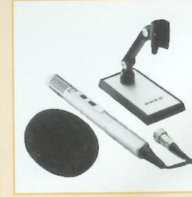
M 650 Electret-Kondensator-Mikrofon Mikrofon mit Start/Stop- und Sprache/Musik-Schalter. Empfindlichkeit: -68 dB (120° Stereo Position) Frequenzbereich: 50-18000 Hz Impedanz: 600 Ohm Batterie: U M3 1,5 V Batterie Lebensdauer: 750 Std. Stromversorgung mit eingebauter Batterie oder über Tonbandgerät mit 8-pol-Mikrofonstecker mit Renkverschluss. Für CR 240 AV, CR 260 AV und Report-Monitor 4200/4400.
