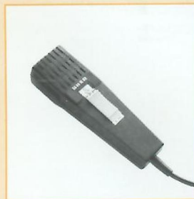
M 155 Dynamisches Diktiermikrofon Steuerschalter für Aufnahme, Wiedergabe, Stop und Wiederholung. Charakteristik: Kugel Empfindlichkeit: 2,5 mV/Pa Frequenzbereich: 150-10000 Hz Impedanz: niederohmig Für Universalgerät 5000.
