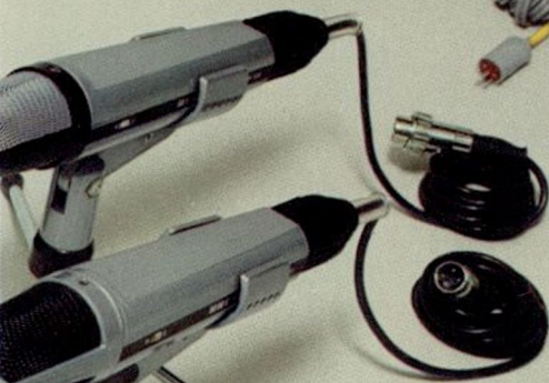
Studiomikrofon M 539 Hochleistungs-Mikrofon mit Kugelcharakteristik. Elastisch gelagertes Mikrofon-System, komplett mit Stativanschlußteil M 937 und Tischstativ M 923. Ohne Anschlußkabel. Frequenzbereich: 40 – 17 000 Hz.
