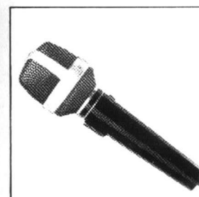
Dynamisches Fernsteuer-Mikrofon M 514 Spezialmikrofon mit Start/Stop- und Sprache/Musik-Schalter. Nierenförmige Richtcharakteristik. Durch Windschutzkappe besonders auch für Außen-aufnahmen geeignet. Frequenzbereich: 70–14 000 Hz.
