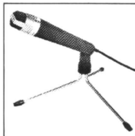
Dynamisches Stab-Richtmikrofon M 534 Tischmikrofon mit nierenförmiger Charakteristik. Sprach-/Musik-Umschalter. Frequenzbereich: 50–18 000 Hz. Als Paar für Stereo-Aufnahmen geeignet; hierzu Stereo-Schiene M 925 lieferbar. Für Universal 5000 Reduzierstück K 836 verwenden.
