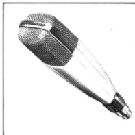
Studio-Richtmikrofon MD 421-2 Hochleistungsmikrofon mit nierenförmiger Richtcharakteristik. Frequenzbereich: 30–17 000 Hz. Für UNIVERSAL 5000 Reduzierstück K 836 verwenden.
