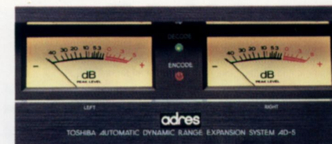
Die beiden Spitzenpegel-Meßinstrumente des AD-5 sind äußerst vielseitig für jede Art von Pegelcheck, aufgrund der ultraschnellen Anstiegszeit von 10 ms, verwendbar.
