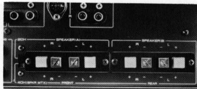
Lautsprecher-Anschlüsse und Umschalter 2-Kanal auf 4-Kanal-Betrieb.
