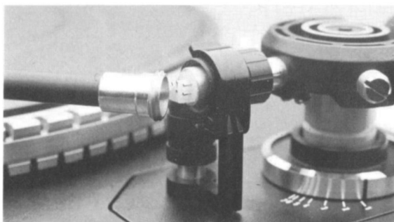
Die Motoren sind schwingungsdämpfend in Gummilagern aufgehängt (Bild oben, TD 115). Für die Tonabnehmer-Montage wird der vordere Tonarmteil abgenommen (Bild unten).
