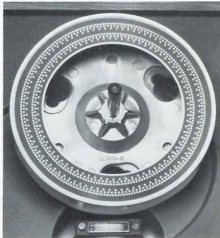
Unter dem Plattenteller ist die Teilung für die 3 Geschwindigkeiten sichtbar
