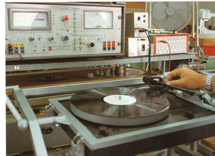
Konstante Werte: Gleichlaufschwankungs-Meßplatz Constant values: Measuring desk for wow and flutter
