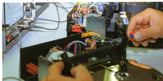
Präzise Verarbeitung: Justierung der Haubenmechanik Precision workmanship: Adjusting the dust cover hinge
