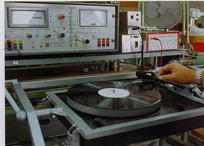
Konstante Werte: Gleichlaufschwankungs-Meßplatz Constant values: Measuring desk for wow and flutter
