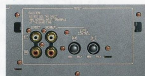
Bi-Amp Anschlüsse der 3000er-Verstärkerkombination mit Level Kontrolle
