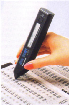
Einlesen der Programmdaten mit Strichcode-Lesestift und Programmiervorlage. Kontrolle der Daten über Display im Lesestift.
