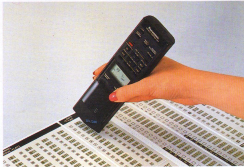
Einfachste Programmierung 1. Einlesen der Timer-Aufnahme-Information mit Programmiervorlage und Strichcode-Lesestift
