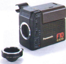
Kamerakörper WVP-F 10 E mit C-mount-Adapter
