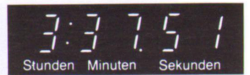
Bandlauf-Echtzeitanzeige. Anfangszeiten von Aufnahmen notieren – problemloses schnelles Finden der Aufnahmen durch Zeit-Suchlauf.
