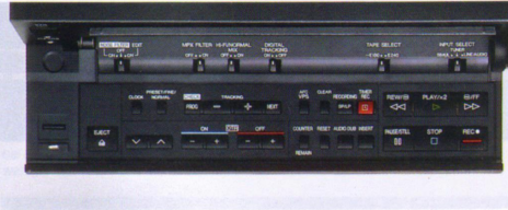
Die aufgeklappte Frontblende enthält die Bedienelemente für die Laufwerksteuerung.
