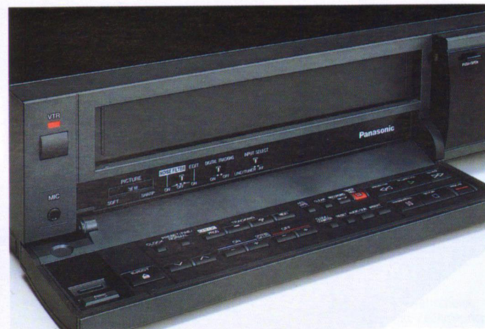
Aufgeklappte Frontblende mit Bedienungselementen
