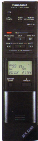
Infrarot-Fernbedienung mit integriertem Barcode-Lesestift und Programmvorlage. Mehr Komfort und mehr Sicherheit beim Programmieren von TV-Aufzeichnungen.
