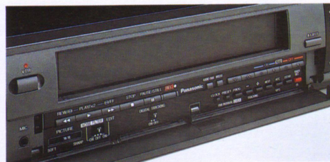
Aufgeklappte Frontblende mit Bedienungselementen
