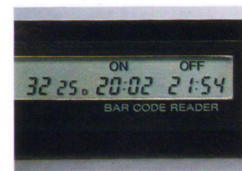
Einlesen der Programmdatei mit Strichcode-Lesestift und Programmervorlage. Kontrolle über Display im Lesestift
