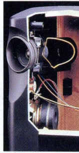
Querschnitt des Lautsprechers
