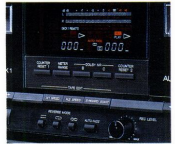
RS-X501 Großes zentrales Fluoreszenzdisplay mit doppelten elektronischen Zählwerken
