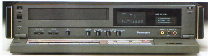
Hinter der aufklappbaren Frontblende mit „Ländertasten“ (siehe Foto unten) finden Sie u. a. die Fernsehnorm-Umschaltung. Praktisch auch die Anschlußbuchsen an der Frontseite.
