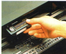
Der NV-V 8000 E ist der erste Videorecorder, der sowohl das VHS-Vollformat als auch Cassetten des VHS-C-Formats ohne Adapter abspielen kann. Die Größe des Cassettenfachs verändert sich auf Tastendruck, die Bandführung wird automatisch in die jeweils richtige Position gebracht und eine intelligente Bandspannungsregelung sorgt immer für einen gleichmäßigen Bandzug. Und somit für eine stabile Bildqualität.
