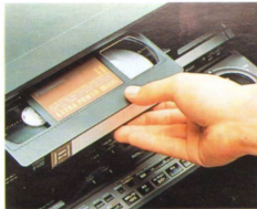
Der NV-V 8000 E ist der erste Videorecorder, der sowohl das VHS-Vollformat als auch Cassetten des VHS-C-Formats ohne Adapter abspielen kann. Die Größe des Cassettenfachs verändert sich auf Tastendruck, die Bandführung wird automatisch in die jeweils richtige Position gebracht und eine intelligente Bandspannungsregelung sorgt immer für einen gleichmäßigen Bandzug. Und somit für eine stabile Bildqualität.
