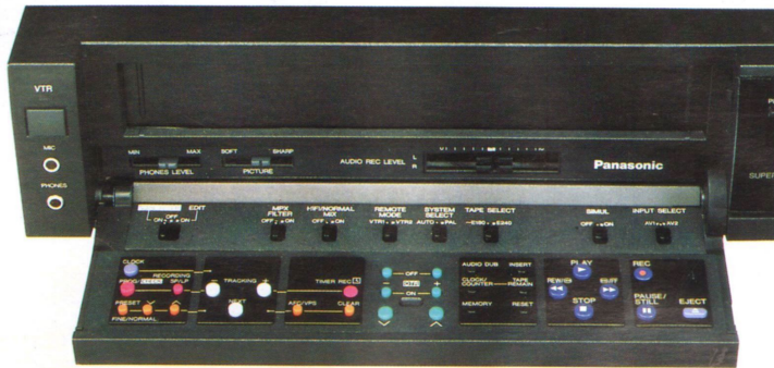
Aufgeklappte Frontblende mit "Domino"-Bedienfeld. Farbige Tasten führen sicher zur Programmierung und Speicherung.
