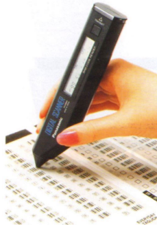
Einlesen der Programmdaten mit Strichcode-Lesestift und Programmervorlage. Kontrolle der Daten über Display im Lesestift.
