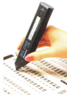
Einlesen der Programmdatei mit Strichcode-Lesestift und Programmervorlage. Kontrolle der Daten über Display im Lesestift.
