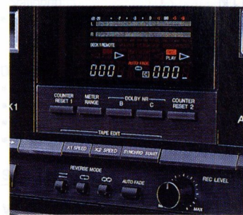
RS-X501 Großes zentrales Fluoreszenzdisplay mit doppelten elektronischen Zählwerken
