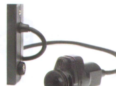
Die Micro-Kamera WV-F 5 E. Mit viel „Spielraum“ für Optik- und Mikrofon-Einheit um die Electronic im Jackettaschenformat.
