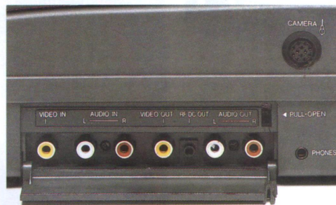
Die externen Anschlußmöglichkeiten.
