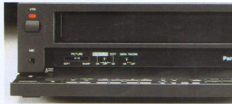
Hinter der aufklappbaren Frontblende finden Sie ein umfangreiches Tastenfeld für die vielfältigen Anwendungsmöglichkeiten.
