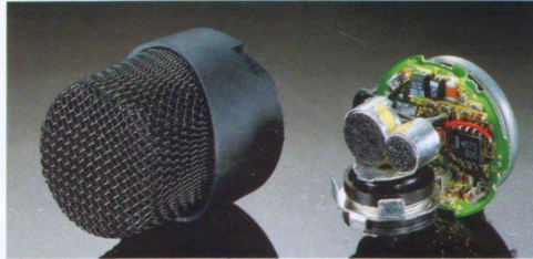
Das Zweifach-Mikrofonsystem vereint in sich die Vorteile eines Kugelkopf- und eines Richtmikrofons. Es reduziert mechanische Geräusche und Windrauschen und gewährleistet so klare Tonaufnahmen in praktisch allen Aufnahmesituationen.
