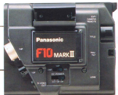
Kamerakörper mit Anschlußmöglichkeiten
