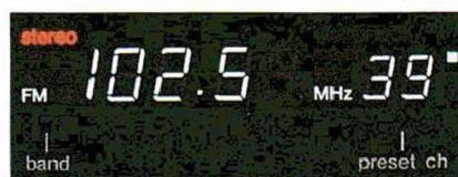
Frequency and channel number indication Affichage de la fréquence et de l'adresse mémoire
