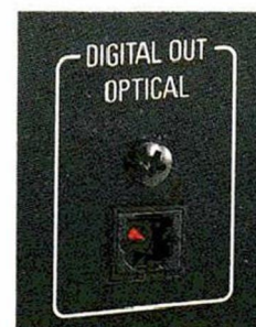
Optical digital output Sortie optique du signal numérique
