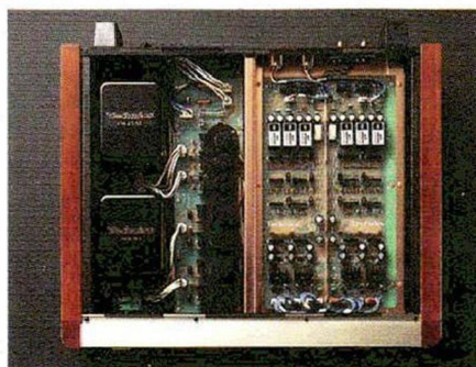
SH-X1000 internal construction SH-X1000 Schéma de principe
