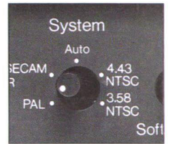
4 Normen-Umschalter für PAL/SECAM (IDDRI)/3,58 NTSC/4,43 NTSC (Ausschnitt aus Bedienungspanel)
