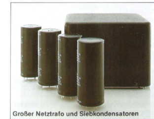
Großer Netztrafo und Siebkondensatoren
